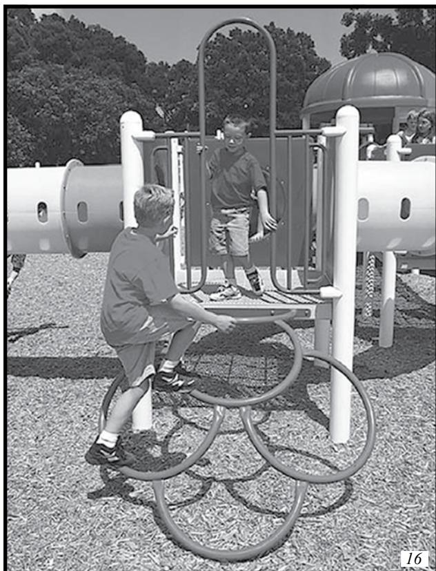
*Cet appareil à grimper est considéré une composante surélevée, puisqu'on peut y avoir accès à partir du niveau du sol ou de plus haut au moyen d'une plateforme ou d'un palier sur une structure de jeu combinée.*
