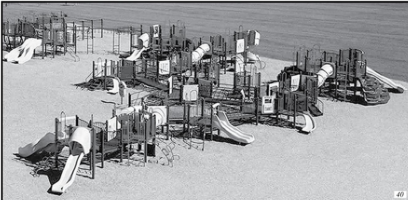
*Cette aire de jeu est équipée de plus de 20 composantes de jeu et fournit l'accès aux composantes de jeu surélevées au moyen de rampes. Le système de rampes, qui consiste en rampes d'accès et paliers, doit relier au moins 25 pour cent des composantes de jeu surélevées. Le reste des composantes surélevées qui doivent être situées sur une voie accessible peuvent être reliées au moyen du système de rampe, ou par un système de transfert.*
