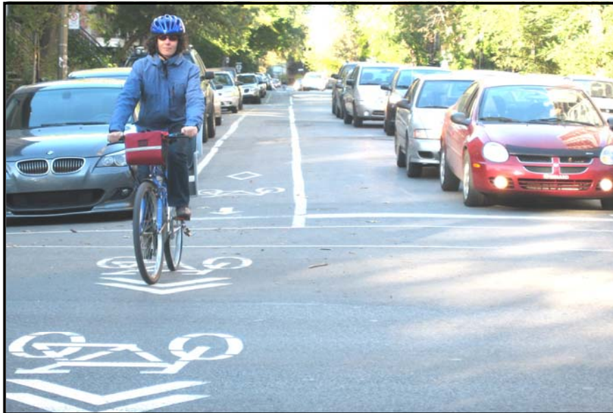
Figure 5 : Bande cyclable située entre la voie de stationnement et la circulation automobile
