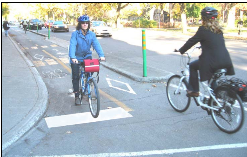
Figure 7 : Bande cyclable bidirectionnelle sur chaussée avec bordure
