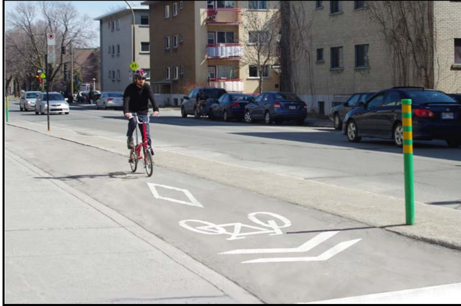
Figure 11 : Exemple de piste cyclable unidirectionnelle avec bordure continue à l'intérieur de l'emprise
