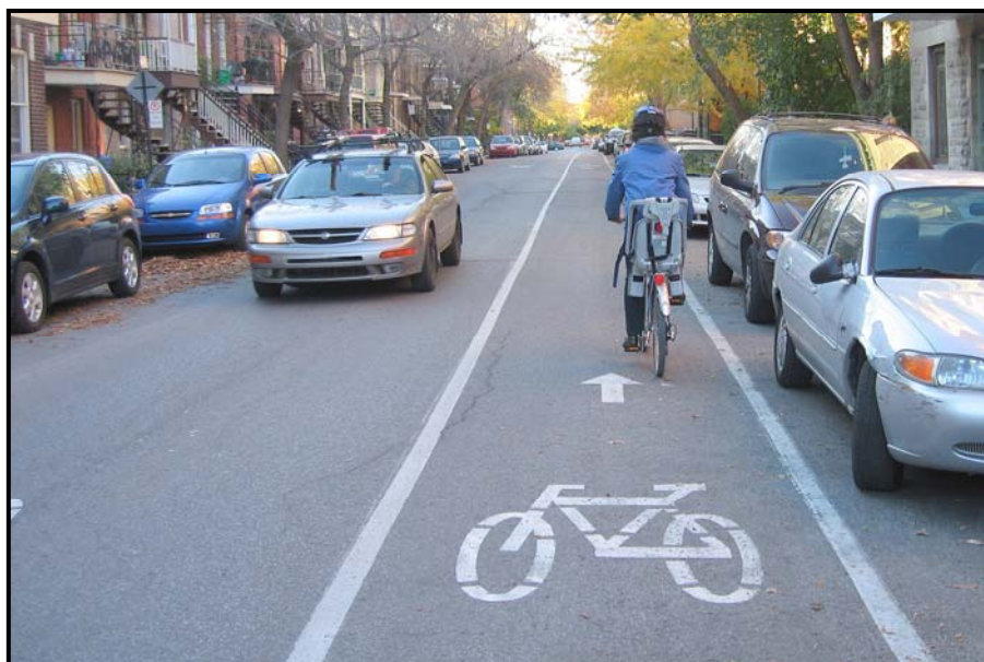
Figure 6 : Bande cyclable unidirectionnelle à contresens dans un sens unique
